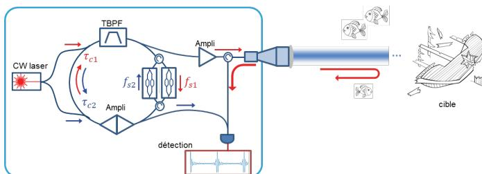
**Schéma du système.** La double boucle à décalage de fréquence contient un amplificateur, un filtre (TBPF) et un décaleur de fréquence non-réversible. Un des peignes de fréquences est envoyé vers la cible, puis recombinié avec l'autre peigne sur le détecteur.
