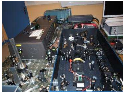
Fig. 8 : Photographie du montage de spectroscopie teraHertz à 800 nm dans le domaine temporel.
